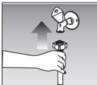
В данную стиральную машину подается только холодная вода. Подключение к водопроводу производится с помощью синего шланга, входящего в комплект поставки.
