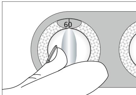
Поверните ручку термостата по часовой стрелке и установите ее на нужную температуру. Если ручка установлена на значок холодной воды, то стирка производится при температуре водопроводной воды. При необходимости можно включить режим половинной загрузки и/или режим остановки после полоскания. Поместите стиральный порошок и умягчитель в соответствующие отделения распределителя и закройте его.
